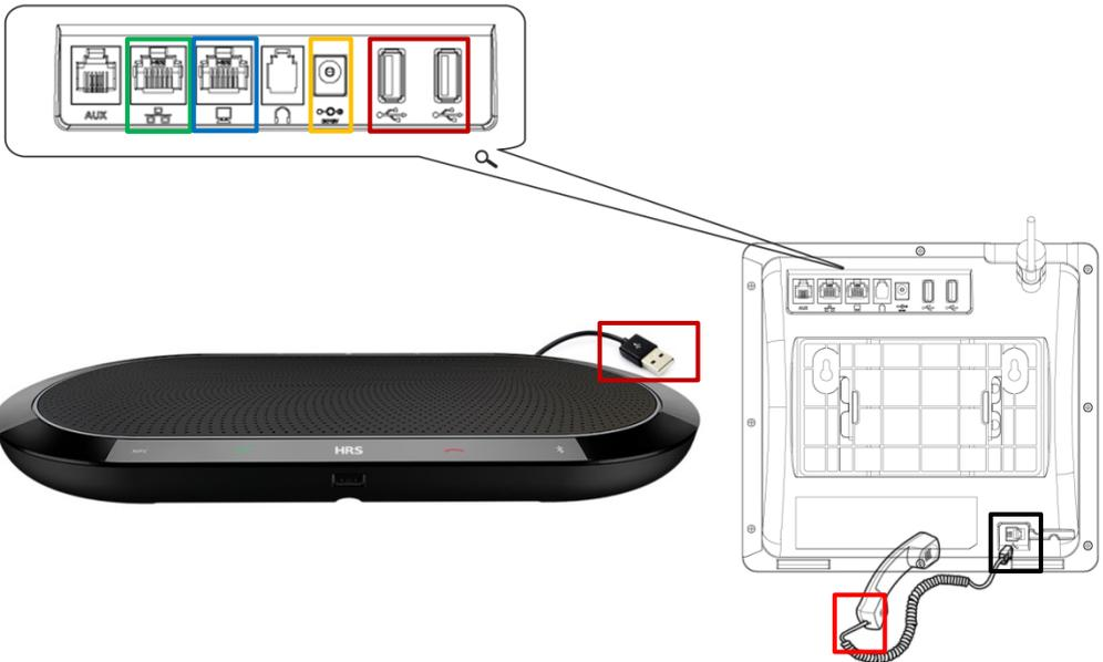
1. Verbinden Sie das kurze **Ende** des Telefonkabels mit dem Hörer.
