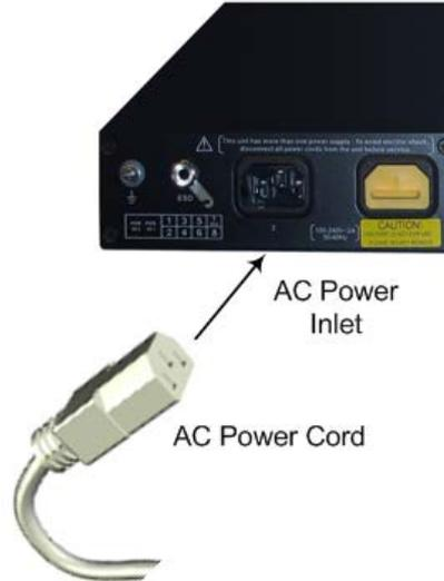
设备接通电源后, 电源模块前面板上的电源LED 会显示绿色。如果 LED 熄灭, 则可能存在电源问题。
