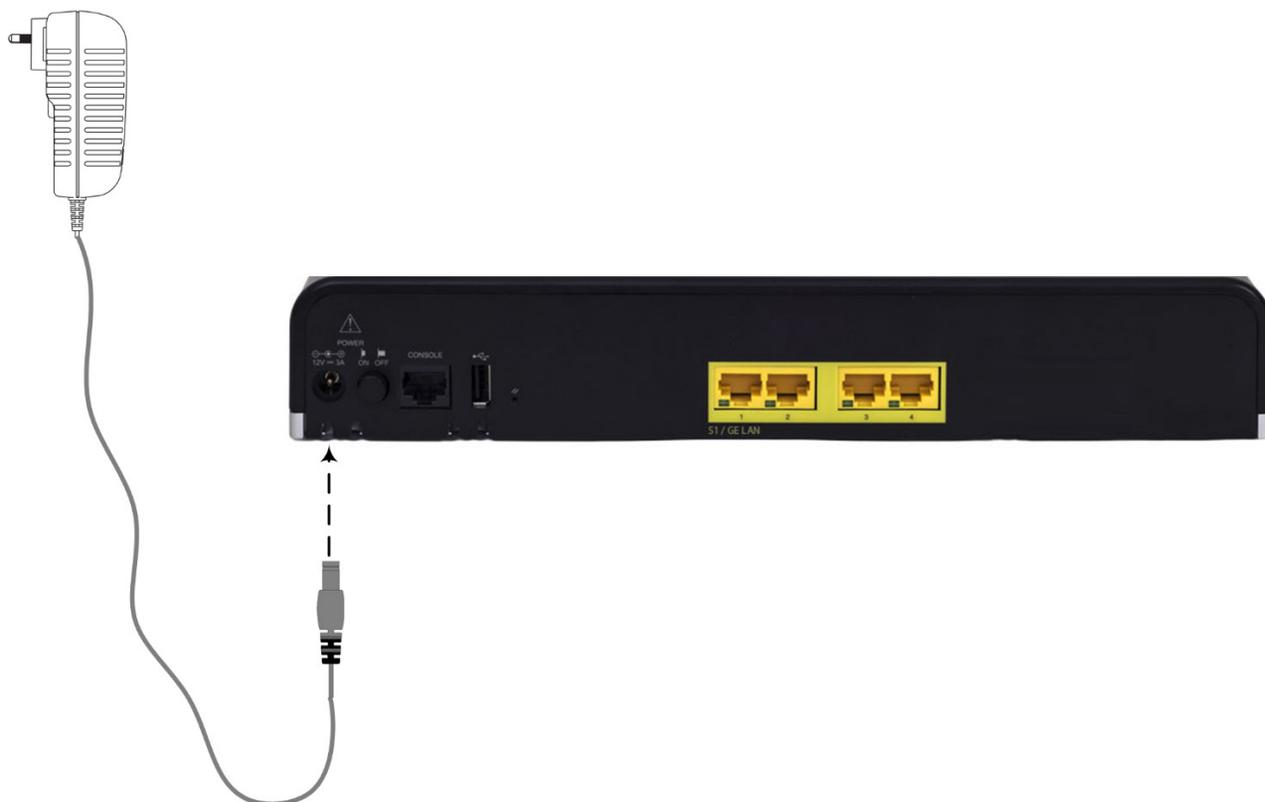
4. Mettez l'appareil sous tension en actionnant le bouton d'alimentation situé sur le panneau arrière. Une fois l'appareil sous tension, le voyant **Power** s'éclaire (vert).
