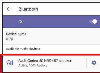
4. Um die Kopplung eines Geräts aufzuheben, öffnen Sie das in der oberen Abbildung gezeigte Bluetooth-Fenster (**Settings > Bluetooth**) und tippen auf
